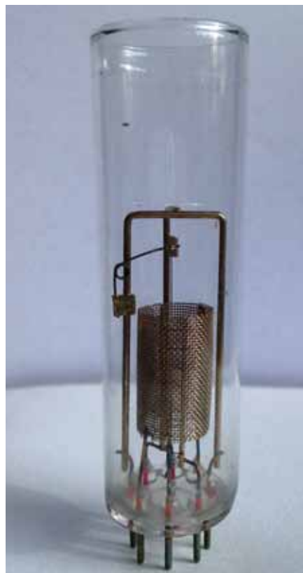
Een ouderwetse triode ionisatiemanometer.
