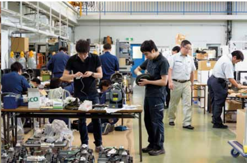
Het jaarlijkse groot onderhoud aan de scrollpompen van de synchrotron van KEK.
