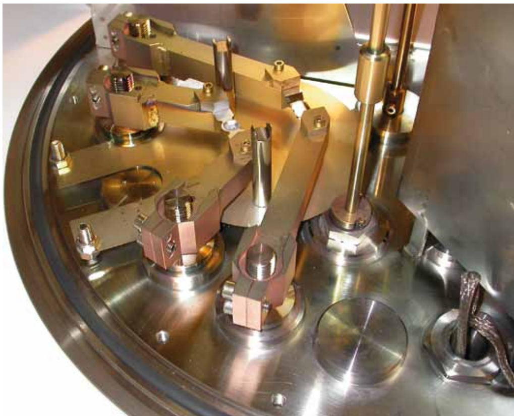
Opdampen door middel van weerstand verhitten.
