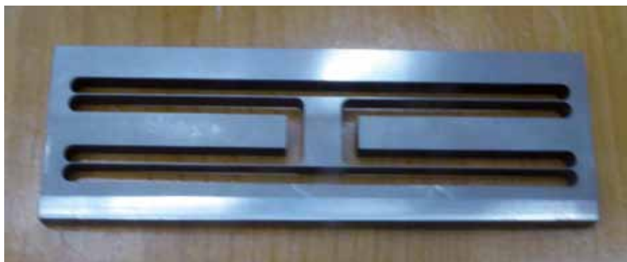
Dunne bladveer, gemaakt met een draadvonkmachine.
