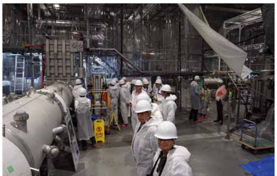
We zien heel wat grote metaalafgedichte vacuümvaten, die alle apparatuur herbergen. Op de achtergrond zie je een enorme VAT-gatevalve.
