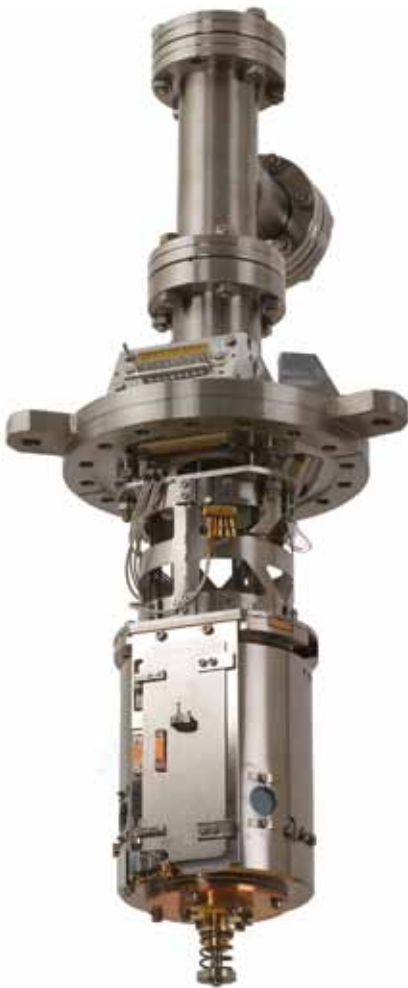
Figuur 5 Het instrument (Fermi SPM) gemonteerd op een CF150-108 flens, buisdiameter 156 mm.
