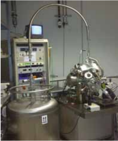
Figuur 9 Koeling, de flowcryostaat is verbonden via een flexibele hevel met een dewarvat. Een beetje overdruk in het dewarvat wordt gebruikt om het vloeibaar helium of stikstof door de cryostaat te laten stromen. Een overdrukventiel begrenst de druk in het dewarvat tot circa 69 mbar voor helium- en 138 mbar voor stikstofkoeling.
