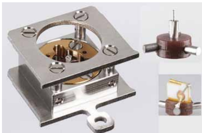
Figuur 8 Links: verplaatsingsmechanisme voor naalden en rechts: naaldhouders voor STM (boven) en QPlus AFM (beneden).
