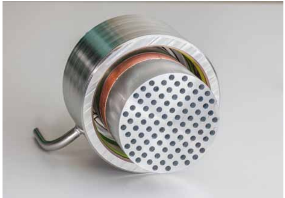
Figuur 3 De omgekeerde borstelektrode, ontworpen door DIFFER.
