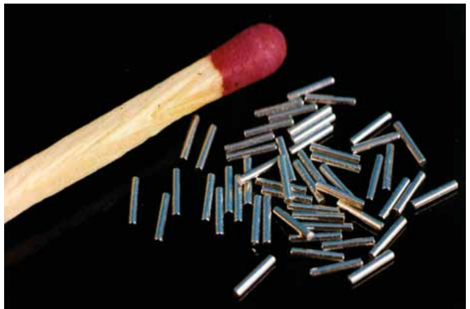
Kleine metalen staafjes van iridium-191 die, na bestraling met neutronen, gebruikt worden voor de behandeling van kanker.
