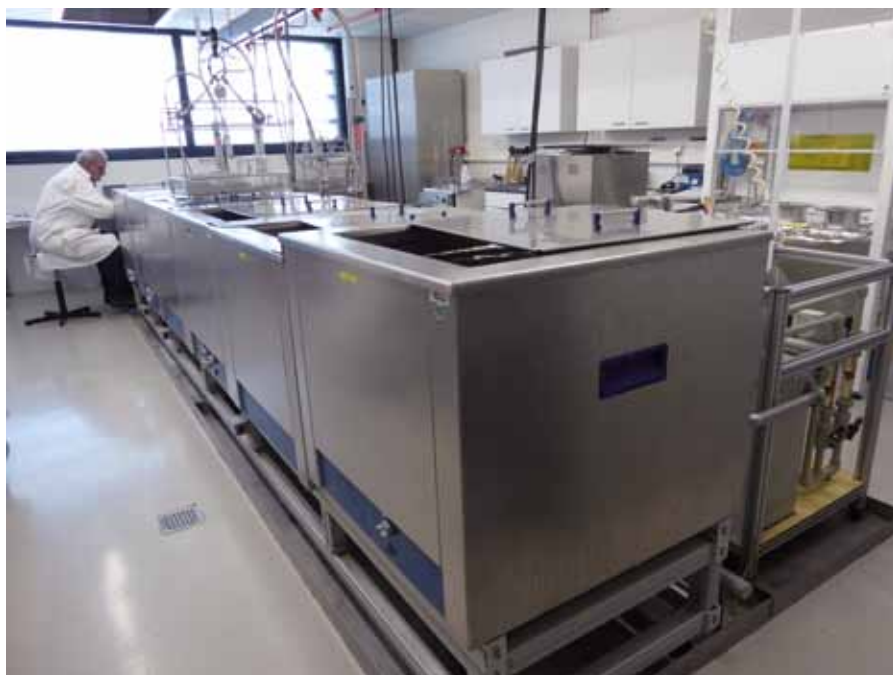
De wasstraat om onderdelen ultraschoon te maken, zes baden met zeep, ultrasoon geluid en demiwater.
