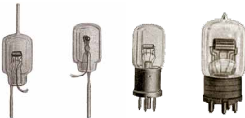
Enkele afbeeldingen van radiobuizen uit Telefunken Zeitschrift [1]. Sommige buizen werden via de bovenkant geëvacueerd en hadden dan, als ze klaar waren, aan de bovenkant een tuitje. Later is men via de onderkant gaan evacueren, zodat het afgesmolten tuitje in de sokkel verdween.
