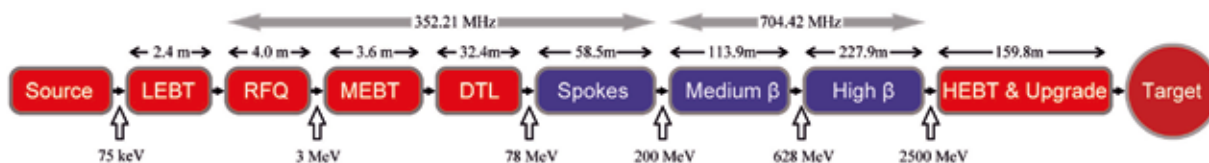
Figuur 1 Het vacuümsysteem van de linac. Voor de ionenbron, Low Energy Beam Transport en radio frequency quadrupole worden turbomoleculaire pompen gebruikt. Voor alle andere systemen worden sputter ionenpompen en NEG-pompen gebruikt. De blauw gekleurde onderdelen zijn supergeleidende cryomodules. Er zijn in totaal 107 afsluiters.
