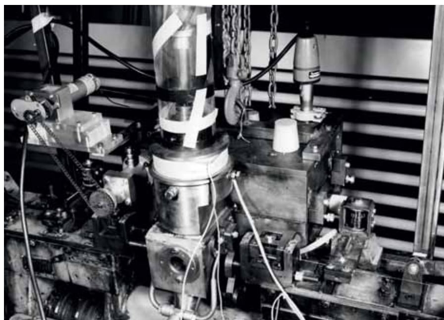
Figuur 7 Proefopstelling voor het lassen van toevoerdraden van lampen. Boven, links naast de kettingen is het prototype gasontladingselektronenkanon te zien. Onderaan de foto gaan van links en van rechts horizontale draden de machine in. Deze worden in het middendeel van de machine gelast, afgeknipt en in een reservoir in het vacuümgedeelte verzameld. Er waren wel grote problemen met het knippen van de draden in vacuüm. Na deze proeven is bij het bedrijf HIG Licht een nieuwe machine gebouwd voor twee kanonnen, die volautomatisch drie draaddelen aan elkaar laste, zeker 500 stuks per minuut.
