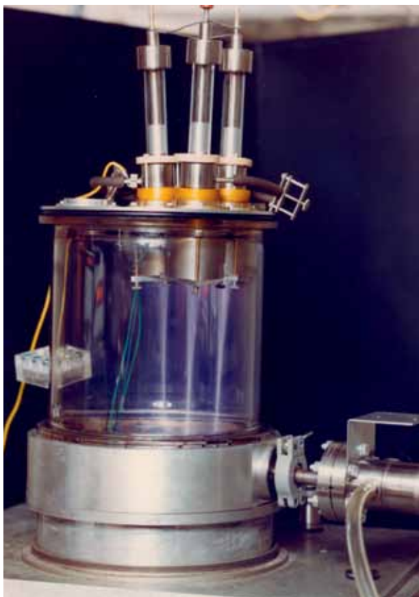
Figuur 1 Opstelling van drie elektronenkanonnen met elk een eigen focuseringsspoel. Hiermee is het mogelijk meerdere lassen tegelijk naast elkaar te maken of dikker materiaal te lassen waarbij bijvoorbeeld twee kanonnen voorverwarmen (een lage stroomsterkte geeft een smallere lasrups).
