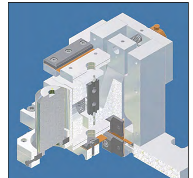
Figuur 3: Linksboven: Overbrengmechaniek met (3:1)-overbrenging, A is de schroefspindel, B is de L-vormige hefboom, C is de overbrenging tussen bladveer en hefboom en D is de bladveerrechtgeleiding.
