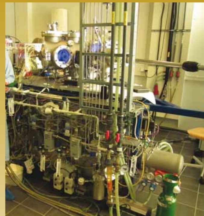
Figuur 1 Links: Foto van de plasmareactor zoals in gebruik op de TU/e voor de chemische-dampdepositie van zinkoxide. Rechts: Een schematische weergave van deze reactor, bestaande uit een cascadeboog (Arc), waarin argon wordt geïoniseerd dat vervolgens onder hoge druk expandeert in de vacuümkamer. In het plasma worden via twee ringen de precursoren zuurstof, diëthylzink (DEZ) en trimethylaluminium (TMA) geïnjecteerd.
