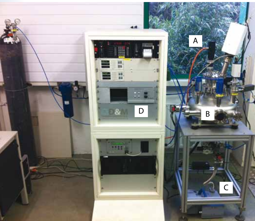
Figuur 1 De opstelling met (A): de druksensoren, andere meetapparatuur en het gemotoriseerd regelbaar lek, (B) de vacuümkamer, (C) de vacuümpomp, en (D) de afleesapparatuur.
